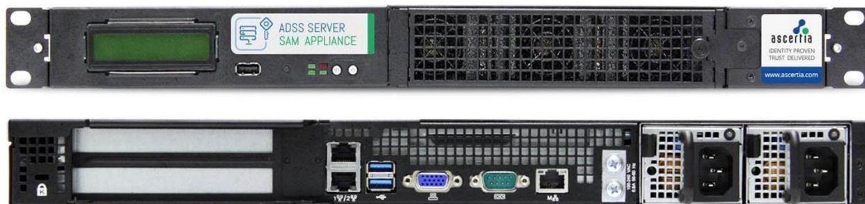
Figura 2 - ADSS Server SAM Appliance: vista frontale (in alto) e posteriore (in basso)
